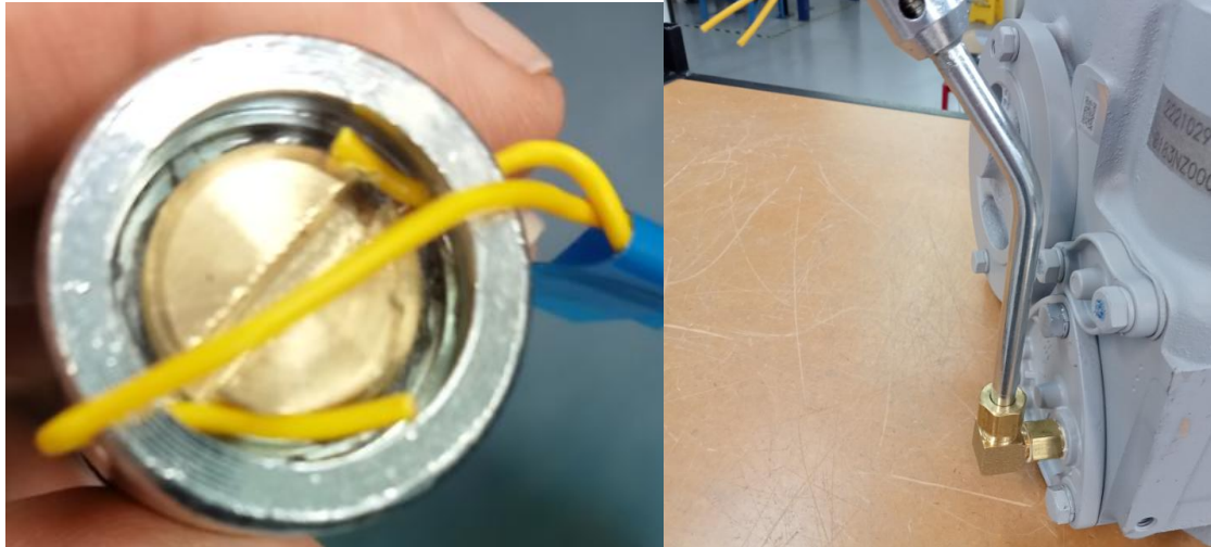
(d) Using sealing wire and plastic seal
