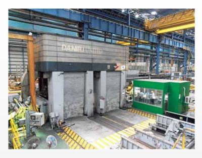
酸鍍廠於1997年建廠完成,並於2018年6月1日併入中鴻,主要產線設備有酸洗線、鍍鋅線、全氫氣式退火爐、精整調質機、張力整平線及自動包裝線等設備,設備主要由義大利Danieli及美國GE所提供。
