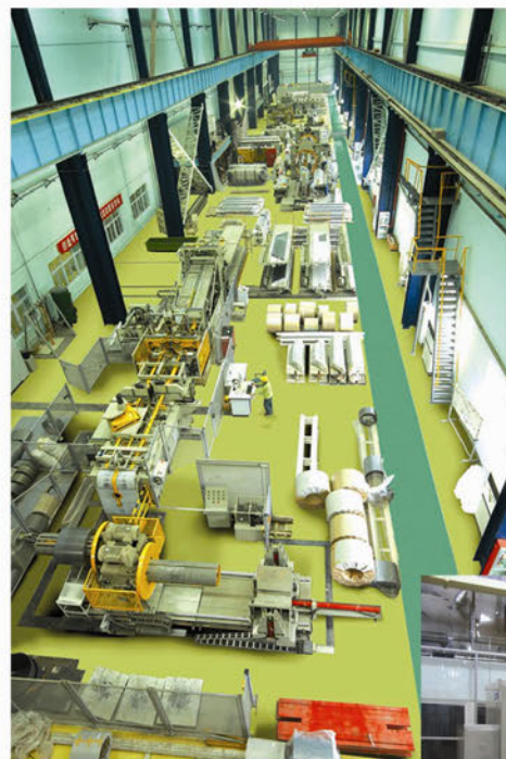
从德国乔格公司引进的硅钢片横剪线 Automatic silicon steel plate cutting line
