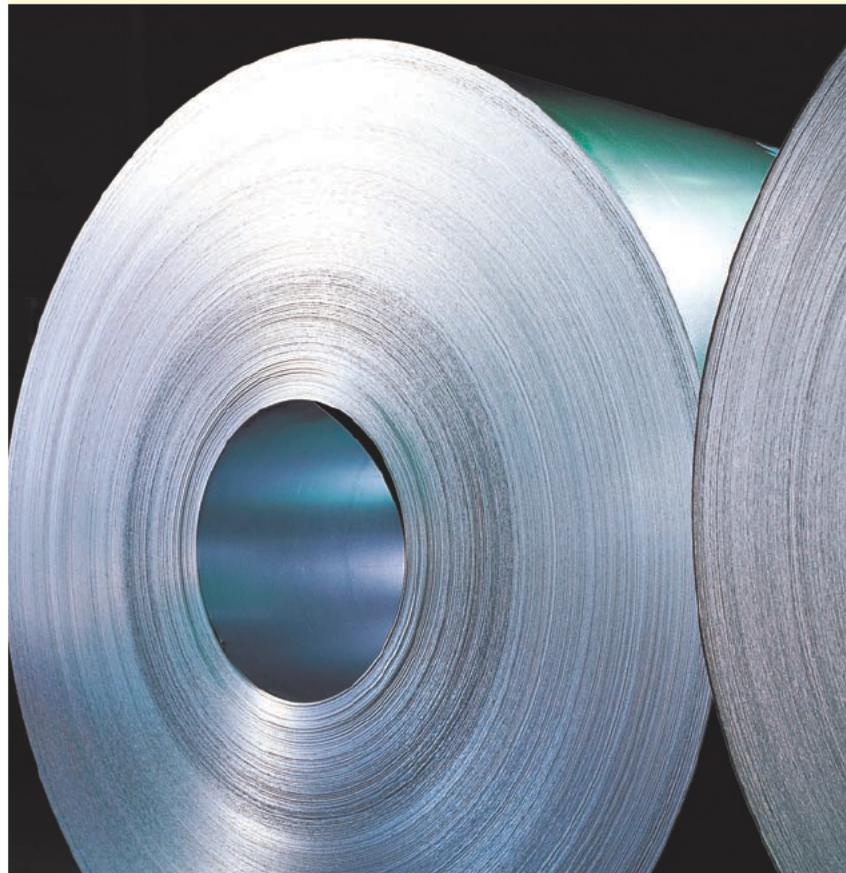
전기아연도금강판은 아연(Zn)이 녹은 전해액을 사용, 냉간압연강판에 전류를 통전시켜 아연도금을 한 제품으로 도금시 열적 영향을 받지 않아 소재의 기계적 성질을 그대로 유지할 수 있습니다. • 또한 용융도금강판에 비해 도금 부착량이 적고 균일해서 용접성과 내식성이 뛰어나며, 기능성 후처리 추가로 도장성이 우수한 제품입니다.
