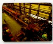
第一條酸洗線/第二條酸洗線 No.1/No.2 Push-Pull Pickling Line(No.1/No.2 PPL)
