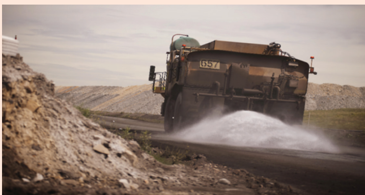
Air disemprotkan pada jalan angkut tambang untuk mengurangi debu di tambang Hunter Valley.
