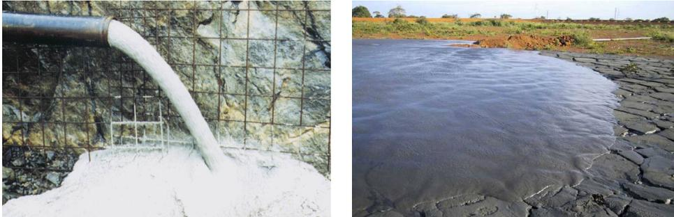
Konsentrasi padatan yang dicapai pada pengeringan bervariasi untuk tailing yang berbeda, karena distribusi ukuran partikel, kandungan mineral tanah liat, bentuk partikel, mineralogi, gaya elektrostatik dan flokulan dosis bervariasi. Tabel 1 memperlihatkan beberapa konsentrasi lumpur dan pasta padat (rasio massa padat ke massa padat ditambah air) khas untuk berbagai jenis tailing.
