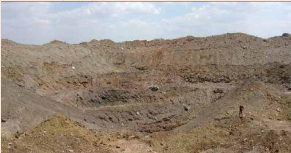
*Gambar 2: Pit contoh yang diekskavasi (level bench 15m) di Main WRD. Skala gambar diberikan oleh seseorang bertinggi 2 m berdiri di sisi kanan.*
