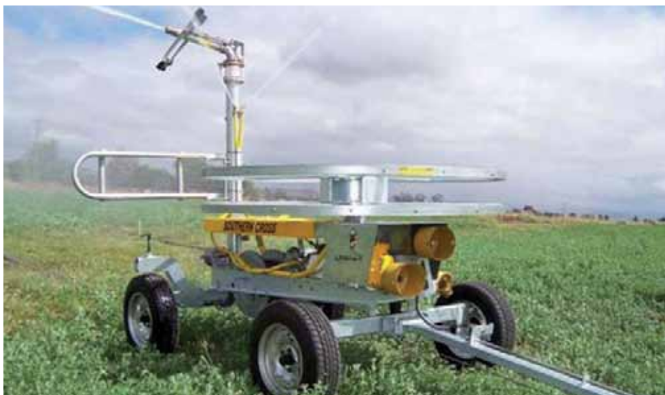
Баруун Австралийн Пилбара бүсийн төмрийн хүдрийн уурхайд ашиглаж буй ердийн зөөврийн усалгааны систем. Эх үүсвэр: Өмнөд Кросс S2500 3500 Операторын гарын авлага V2.
