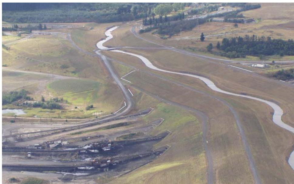
Figura 3. Construcción del desvío del río Morwell
