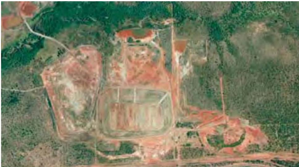
Figura 5.19. Emplazamiento de la mina rehabilitada en 2005, después de la construcción de una cobertura sobre el montón de los desechos de roca
