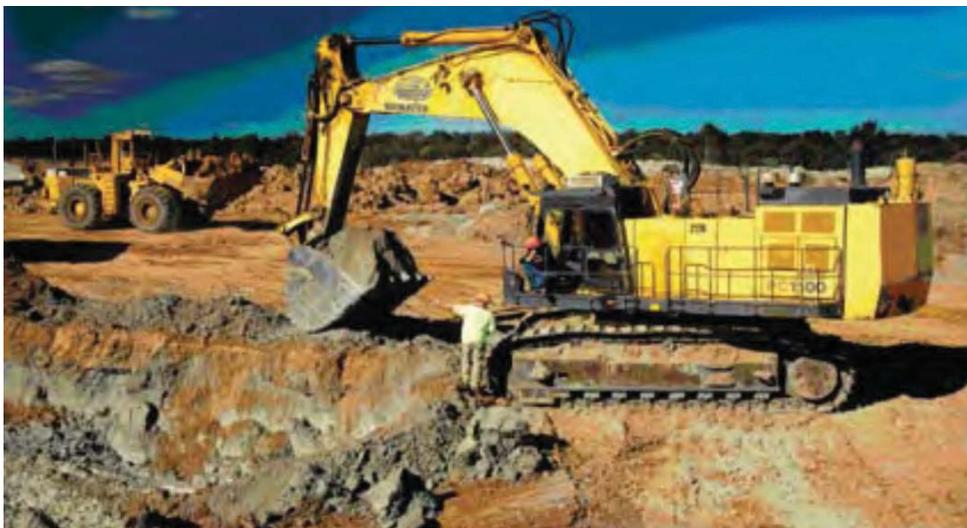
Figura 4.9 Control geológico para separar materiales generadores de ácidos
