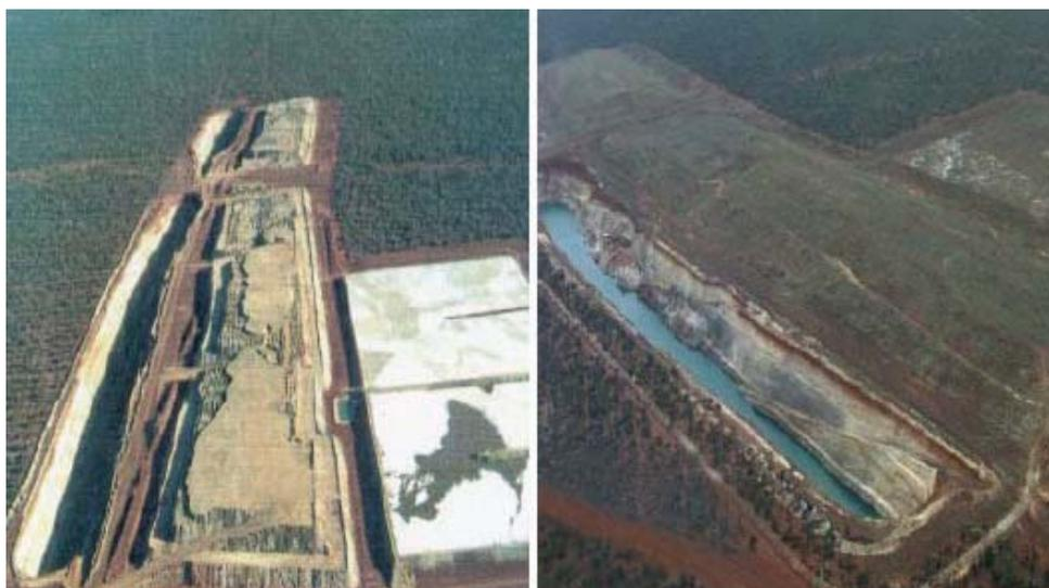
Figura 5.11. La mina de Bottle Creek, antes y después de la rehabilitación
