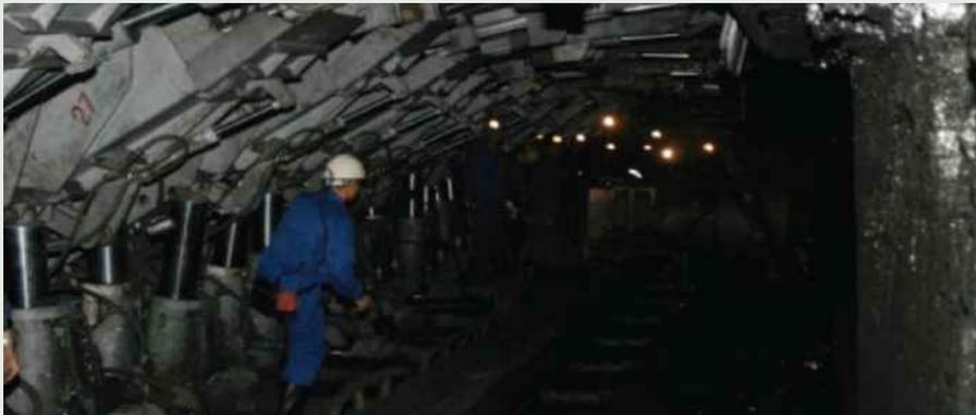
Gambar 4.15 - Muka longwall didukung oleh perisai mekanik, diekstraksi dengan shearer (pemotong berputar) yang diterapkan pada tambang batubara di Vangdanh pada tahun 2007
