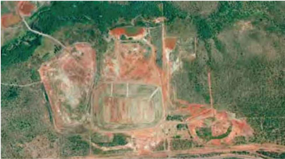
Gambar 5.19 - Situs tambang tahun 2005 yang telah direhabilitasi, menindaklanjuti konstruksi lapisan penutup timbunan batuan limbah.
